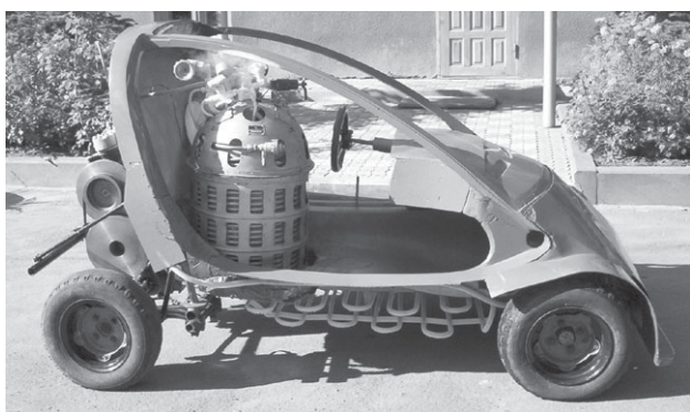
Рис. 2. Пневматический двигатель, испытанный в УСТ, США
