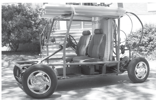
Рис. 3. Экспериментальная модель криогенного автомобиля (Университет Северного Техаса)
